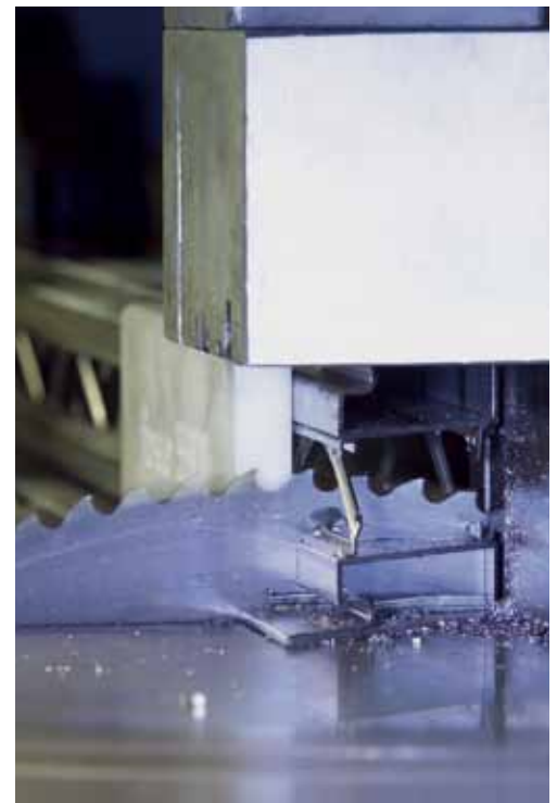
Profilstahlrohre werden auf Mass geschnitten.
