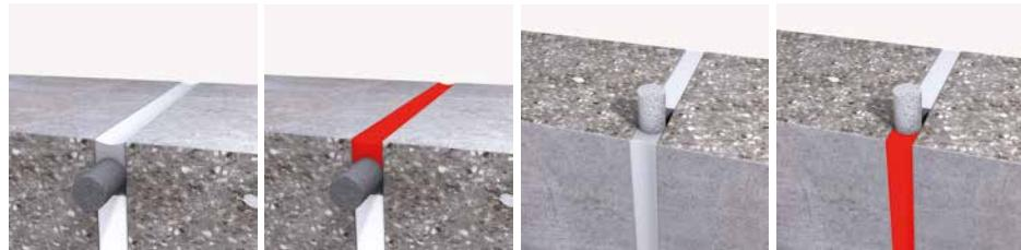
**Hinterfüllmaterial****Fond de joint****M112367**
