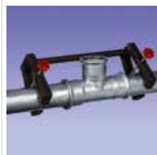
Fig. 20 Utilisation de l'étau à tubes pour les gros diamètres
