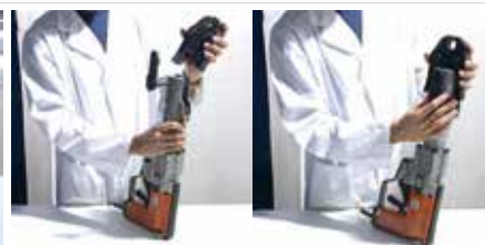
Fig. 18-19 Equiper l'outil de sertissage de la mâchoire adéquate
